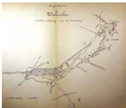
Projekt przebudowy stacji Wieliczka. Na czerwono oznaczono przebieg nowych torów do Mszany. Widoczne bocznice – nie tylko do kopalni, ale także na północ do cegielni oraz do magazynów przy ul. Dembowskiego Źródło: https://upadektechnikrakowa.blogspot.com/search?q=wieliczka (dostęp 27.11.2024)
