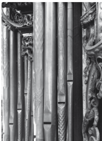
Piszczałki prospektowe Pryncypału 8' wykonane przez Głowińskiego – widoczny sposób realizacji dekoracji metodą „trybowania” w pozytywie dolnym.
