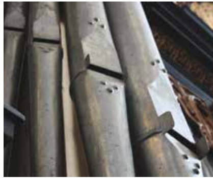
Fragment prospektu organów wielkich – frontowe piszczałki Pryncypału 16’ – widoczny cynowy wałek łączący rezonator z nogą, czyli charakterystyczny sposób lutowania stosowany wyłącznie przez Studzińskiego.
